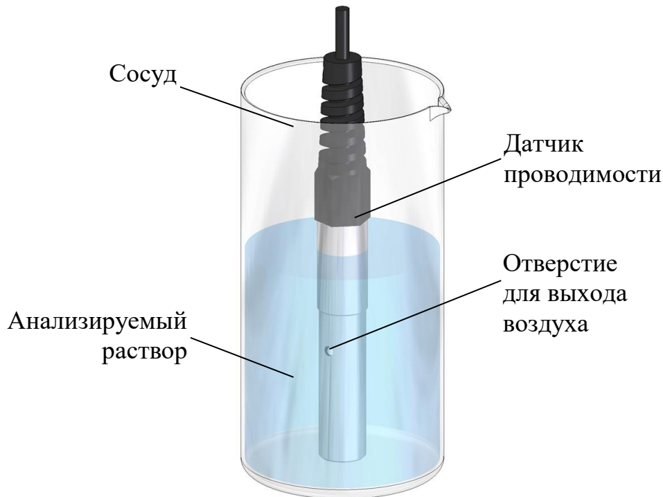
Рисунок 2.3 – Проведение измерений погружным методом
