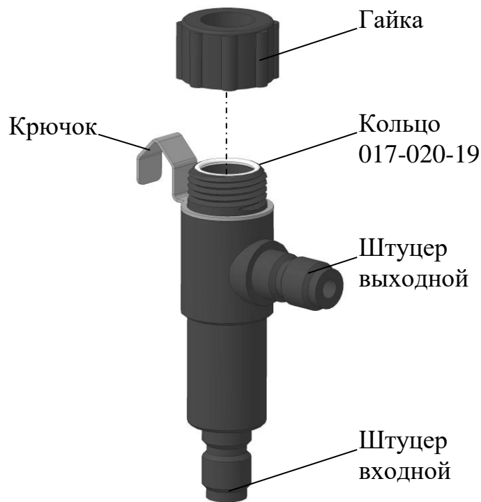
Рисунок 2.5 – Кювета проточная ВР41.15.310
